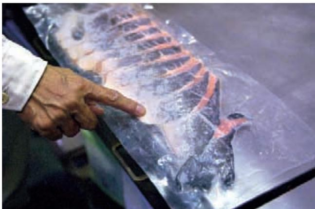
ガチガチに凍った魚を、きれいな切り口で、高速で加工。「匠身」の登場により、温度管理の工程が省け、加工後に再度冷凍庫に入れる必要もなくなる。工場内の工程を大きく改善。
