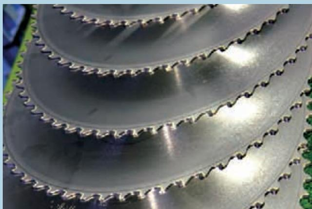
刀鍛冶が小槌で鋼を黒打ちするように、WPC加工で金属表面の硬度も大幅にアップ
