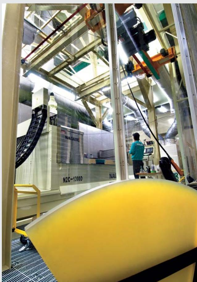
反射鏡を加工する工作機械は重量120トン。機械だけでなく、設置場所の湿度や温度調整など、設備全体のシステムを独自技術で管理している。
