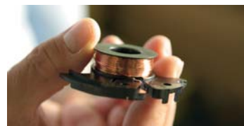
ホーン内部には隙間無く銅線が巻かれている。同社が世界に誇るコア技術のひとつだ
